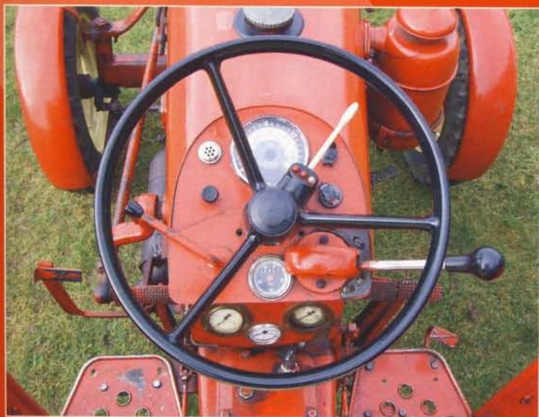
Rauf und runter: Der Hydrostat-Hebel regelte die Fahrgeschwindigkeit.
