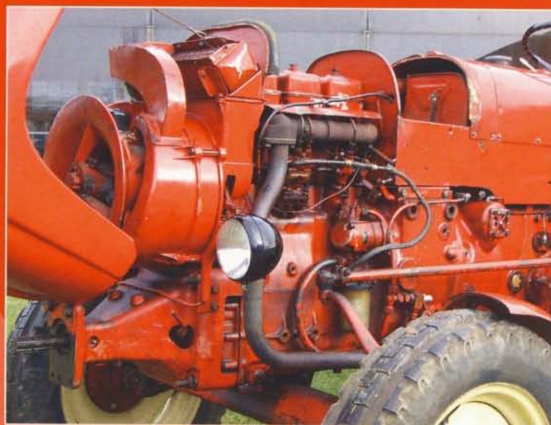
Stufenlos kostet Leistung: Im Vergleich zu Getriebe-Schleppern entwickelte der Super X deutlich weniger Zugkraft.
