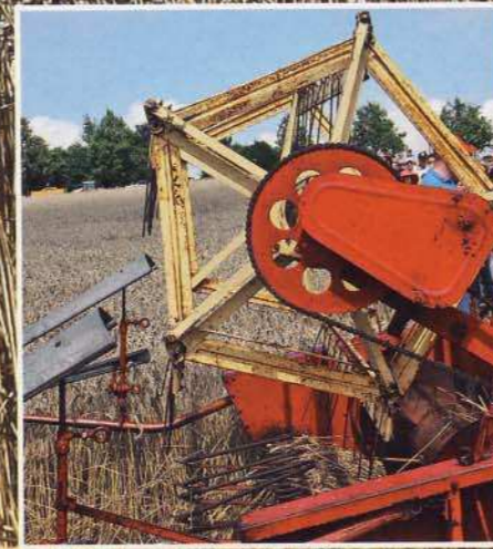
KORN HER: Das Schneidwerk einer McCormick D8-61.
