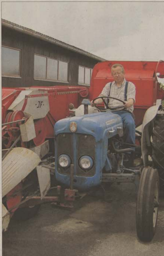
Auch so ein Leckerbissen: Klaus Herrmann präsentiert den Seitenwagenmähdrescher. Der Vorteil der 60er-Jahre-Erfindung ist, dass der Bauer den Mähdrescher abmontieren kann.
