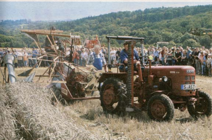
Der Bindemäher Fahr Z10, gezogen von einem Fahr D130 bedeutet einen Quantensprung, weil er das mühsame Binden der Garben miterledigte.
