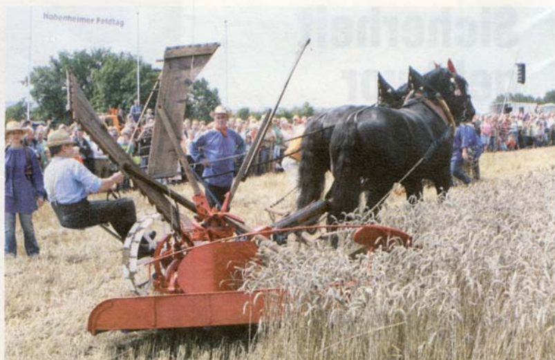
Erste Schritte: In den 1930er-Jahren entwickelten Bautz und Fahr praxistaugliche Mähmaschinen. Im Bild der Fahr „Greif“, ein Flügelabnehmer, der den bei- den vorgespannten Percheron-Kaltblütern einiges abverlangte.
