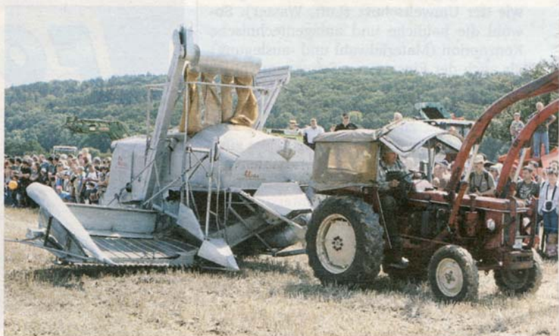
Alles in einer Maschine: Der gezogene Claas Super, Baujahr 1951, revolutionierte die Getreideernte, weil er alle Ernteprozesse vom Schnitt bis zum Drusch erledigte und so bis zu 70 Arbeitskräfte einsparte.
