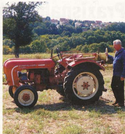
Porsche-Schlepper aus der Zeit des Wirtschaftswunders: Dieses Modell kann zur besseren Übersicht auch im Laufenden gelenkt werden.
