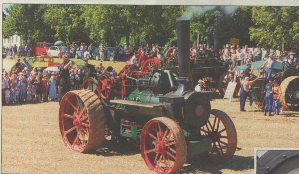
Die zwei Heucke-Dampfplug-Lokomotiven des Deutschen Landwirtschaftsmuseums sind noch betriebsfähig, weil sie zwischen 1988 und 2000 generalüberholt wurden. Die Pfluglokomotiven Typ 287 und 288 stammen aus dem Baujahr 1911. Fotos: Raiser
