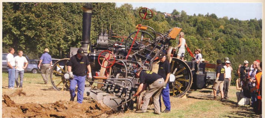
Die Dampfmaschine im Hintergrund hat den Pflug mit einer Seilwinde über das Feld gezogen. Gleich wird der Pflug gekippt, und dann geht es zurück in die andere Richtung.
