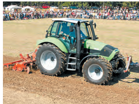
Deutz M 625 , 160 PS, mit Rau Rototiller, 3 m Arbeitsbreite und Tiefenlockerern.
