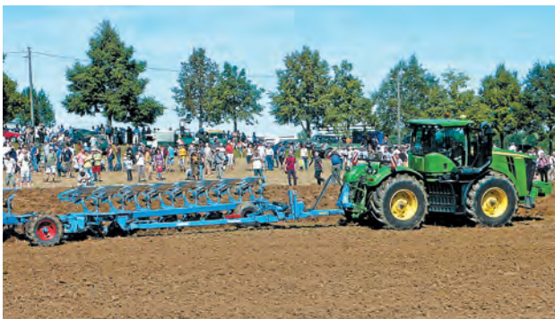
Modernes Kraftpaket: John Deere 9560 R, 600 PS, mit Lemken EuroTitan 8+3-Schar-Pflug.
