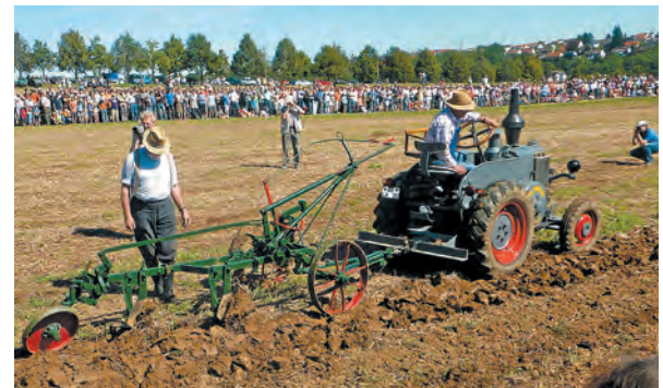
Lanz Bulldog mit angehängtem 2-Schar-Beetpflug von Eberhardt, etwa 1940.
